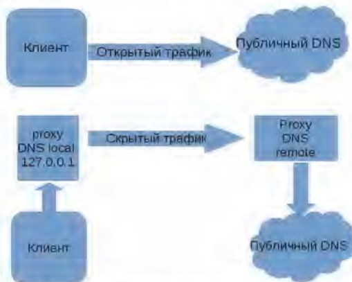
Рис. 1. Схема взаимодействия в традиционном DNS (а) и сервисе DNS Proxy (б)
