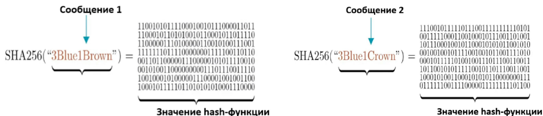
Рис. 5. Иллюстрация свойств хеш-функции: изменение одного символа в аргументе дает полное изменение значения хеш-функции
