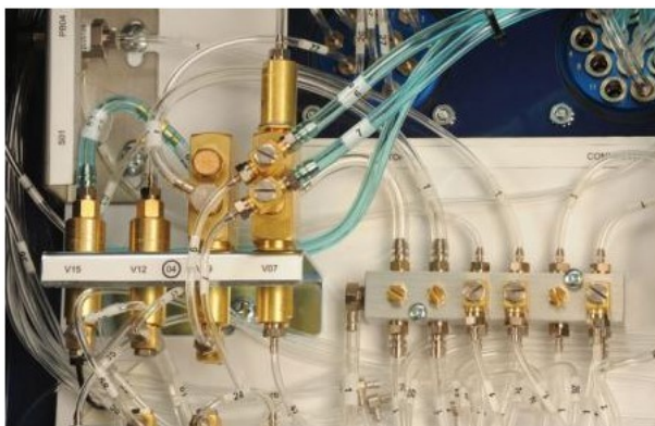
Рис. 3. Фрагмент цифрового пневматического контроллера [7]
